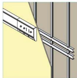
El refuerzo se materializa con dos tramos de perfil Solera de 70mm, atornillados a los perfiles Montante mediante tornillos T1 punta aguja.
